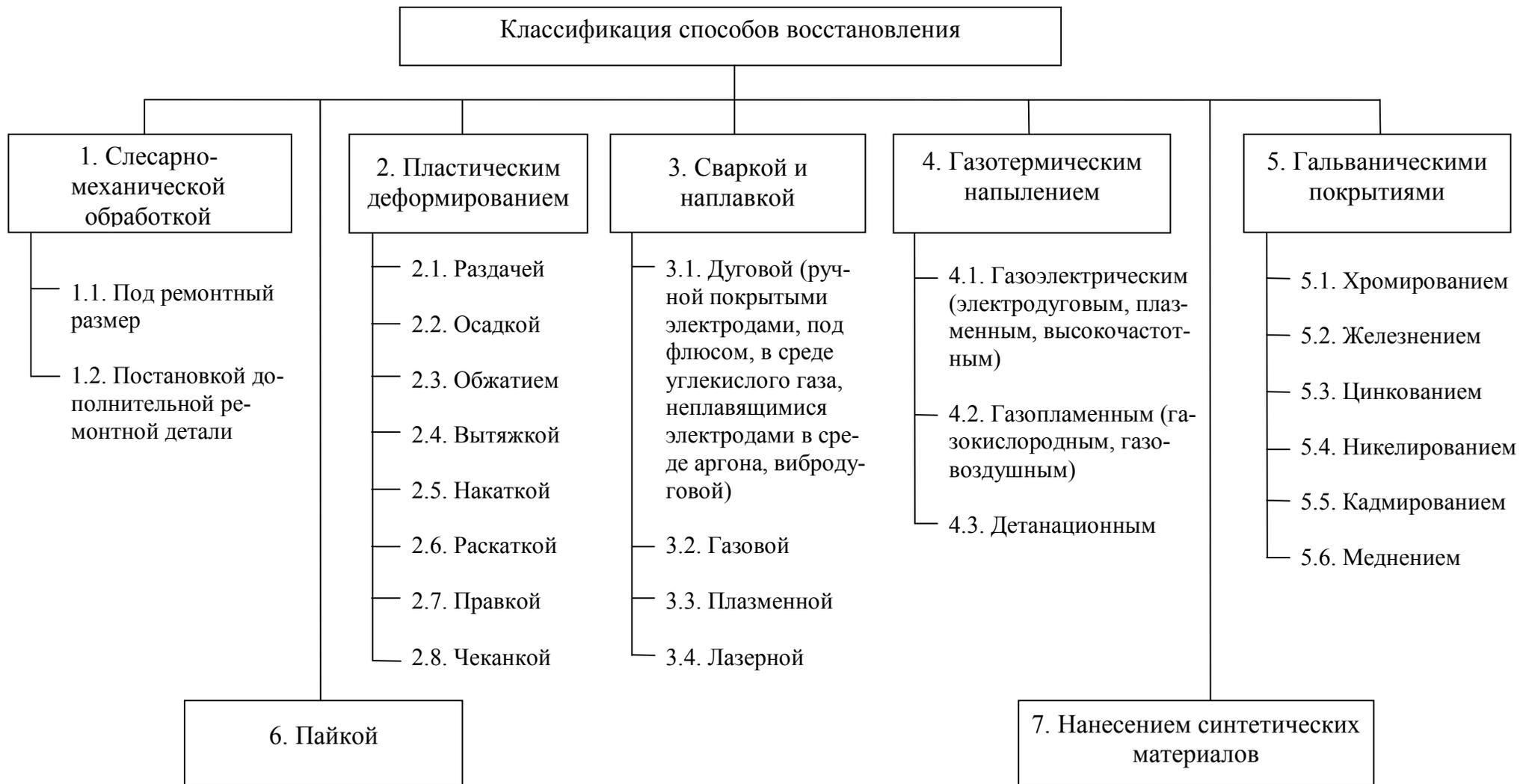
Рис. 18. Классификация способов восстановления деталей
