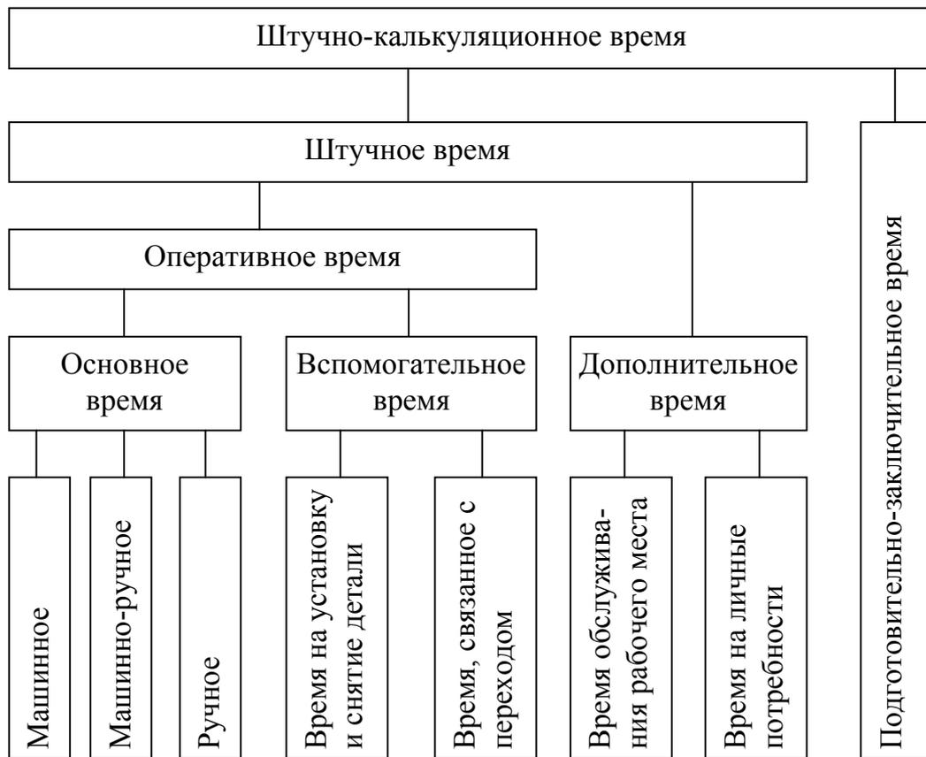
Рис 40. Структура штучно-калькуляционного времени
