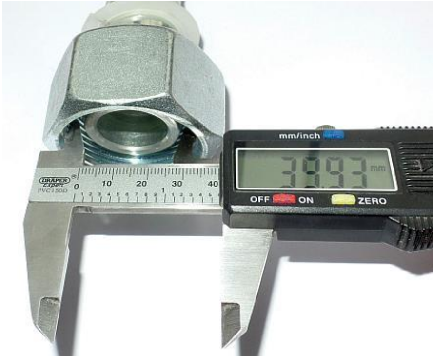
Рис 6.5. Измерение внутреннего диаметра резьбы штангенциркулем
