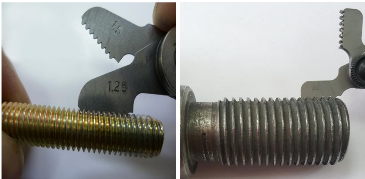
Рис. 6.4. Определение шага резьбы резьбомером
