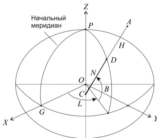
Рис. 1.9. Геоцентрическая земная система координат
