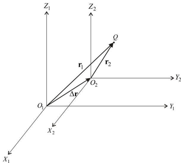
Рис. 1.3. Параллельный перенос осей координат
