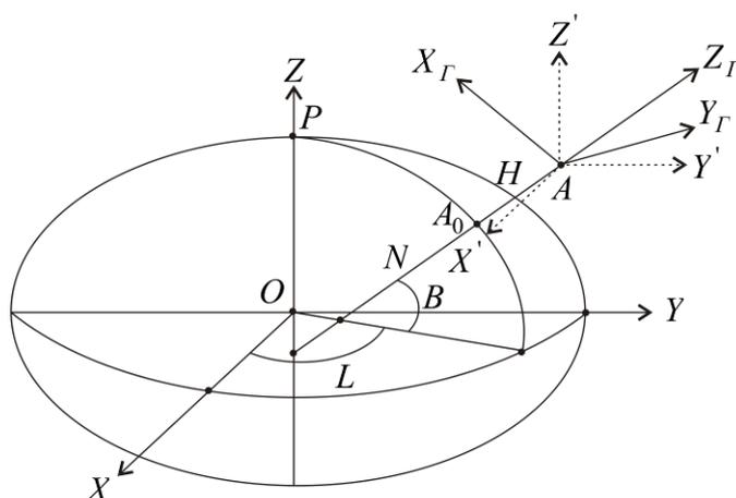
Рис. 1.11. Топоцентрическая система координат
