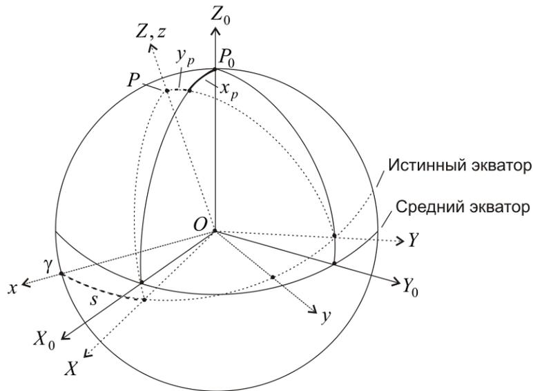
Рис. 1.10. Связь между истинной небесной и общеземной системами координат
