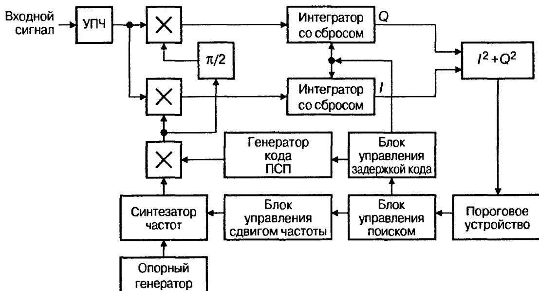
Рис. 2.14. Упрощенная схема устройства поиска
