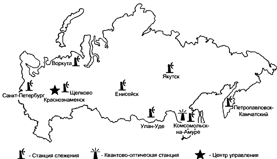
Рис. 3.3. Расположение наземных станций слежения СНС ГЛОНАСС
