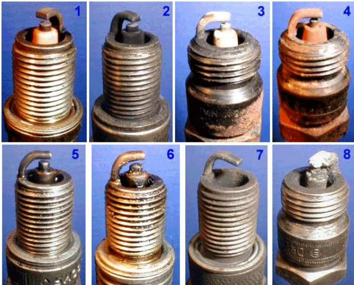
Рис 5.5. Определение состояния двигателя по виду свечей зажигания
