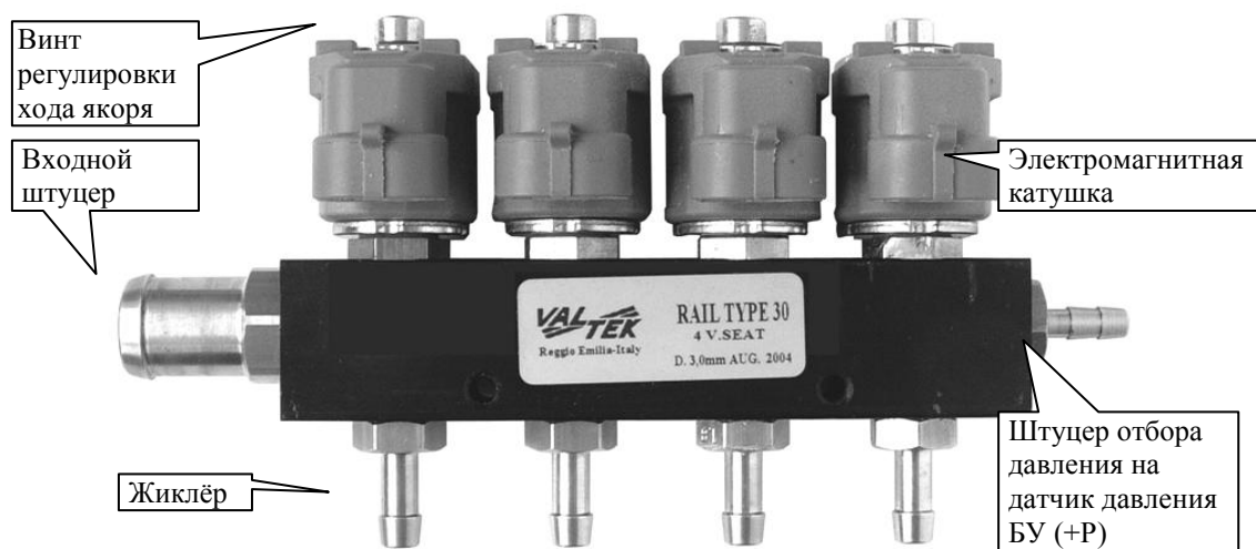
Рисунок 7. Рампа газовых инжекторов фирмы “VALTEK” на 4 цилиндра.
