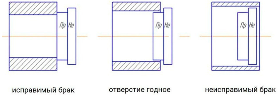
Рисунок - Варианты контроля отверстия калибром "пробка"
