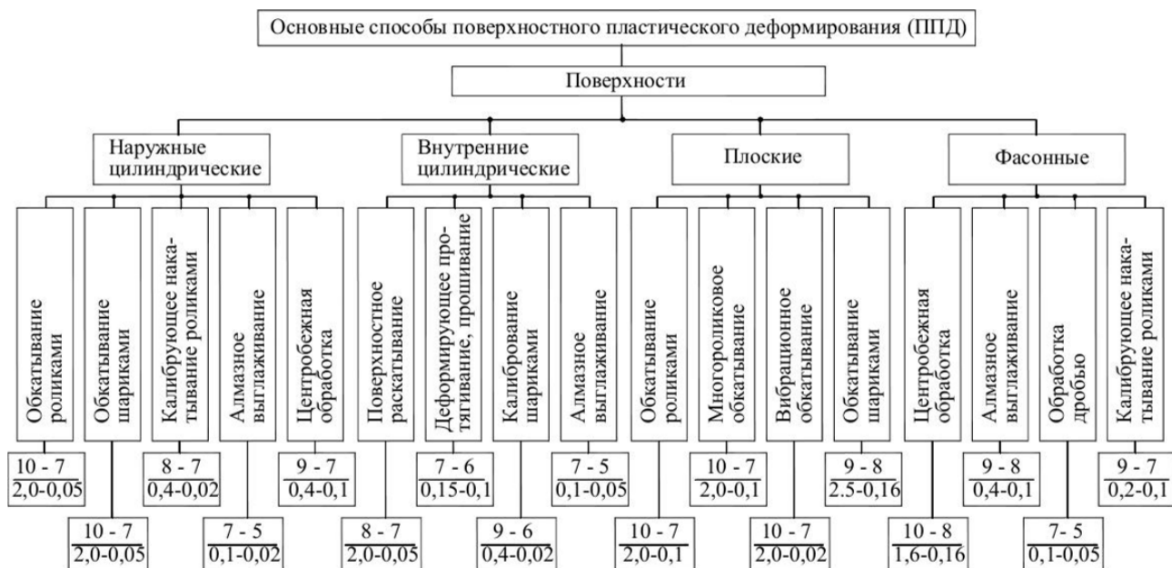
Рисунок - Классификация основных способов пластического деформирования: цифры в числителе означают достигаемые качества точности, в знаменателе - параметр шероховатости Ra, мкм
