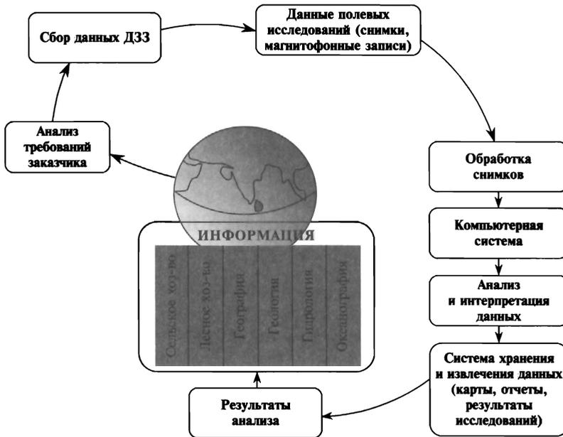
Рис. 1.4. Процесс получения и анализа данных дистанционного зондирования
