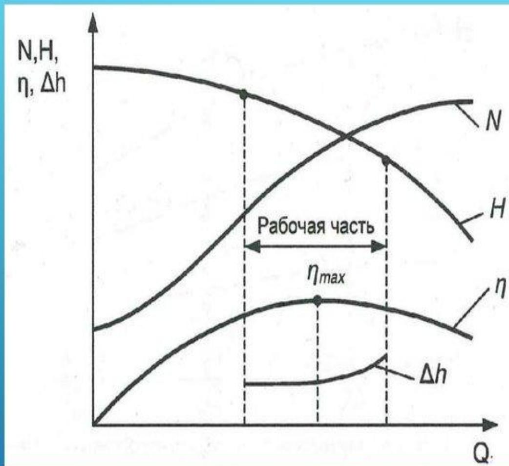
Характеристикой центробежного насоса называется графическое отображение зависимости развиваемого напора  $H$ , потребляемой мощности  $N$ , коэффициента полезного действия (КПД) и допустимого кавитационного запаса  $\Delta h$  от подачи  $Q$ .
