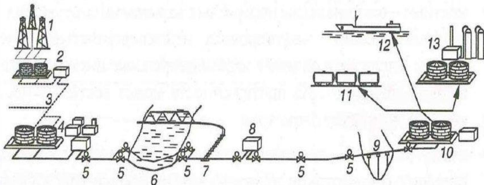
1 – промыслы; 2 – нефтесборный пункт; 3 – подводящие трубопроводы; 4 – головная нефтеперекачивающая станция; 5 – линейная задвижка; 6 – подводный переход; 7 – переход под железной дорогой; 8 – промежуточная нефтеперекачивающая станция; 9 – надземный переход через овраг (ручей); 10 – конечный пункт нефтепровода (нефтебаза); 11 – пункт налива нефти в железнодорожные цистерны; 12 – перевалка на водный транспорт; 13 – пункт сдачи нефти на нефтеперерабатывающем заводе
