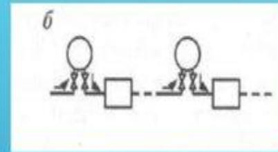
При перекачке через резервуар НПС нефть от предыдущей станции поступает в резервуар и одновременно из него откачивается. При не синхронной работе соседних НПС резервуар служит буферной емкостью. Данная схема позволяет удалять из трубопровода попавший в него при производстве ремонтных работ воздух, а также частично освободиться от воды и механических примесей за счёт значительного уменьшения скорости потока в резервуаре по сравнению с трубопроводом.
