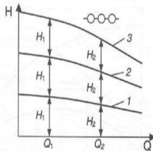
Рис. 3.7. Суммарная характеристика  $H(Q)$  центробежных насосов при последовательном соединении:
