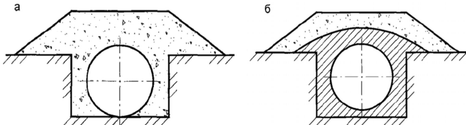
**Рис.3. Полуподземная схема прокладки трубопровода:**
