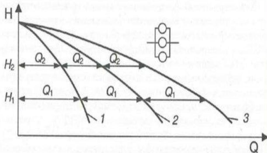
Рис. 3.6. Суммарная характеристика  $H(Q)$  центробежных насосов при параллельном соединении:
