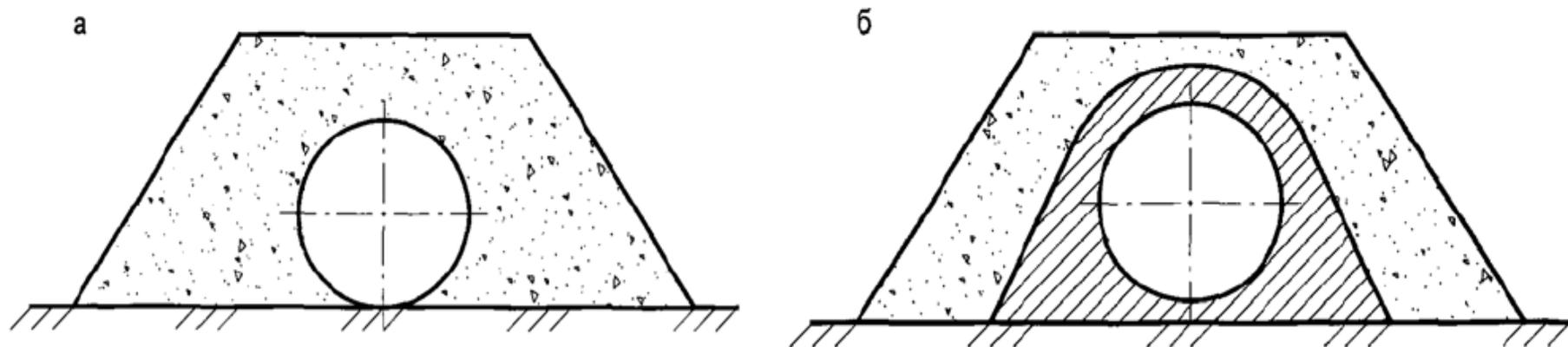
**Рис.4. Наземная схема укладки:**
