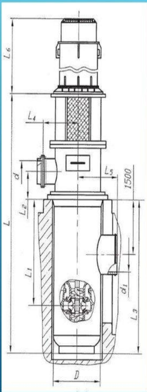
Для надежной и безотказной работы магистральных центробежных насосов требуется обеспечение необходимого подпора, который обычно создается подпорными насосами (на ГНПС), либо за счет напора, передаваемого от предыдущих НПС.
