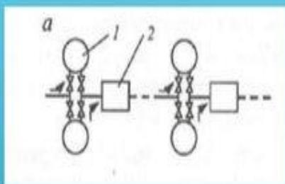
При постанционной схеме перекачки нефть поочередно принимают в один из резервуаров НПС, а откачивают из другого. Эта схема позволяет достаточно точно учитывать перекачиваемую нефть по замерам уровня в резервуарах, при такой схеме осуществляется разгазирование нефти и удаление излишка воды, а также обеспечивается большая надёжность и бесперебойность поставок нефти потребителю за счёт того, что участки могут функционировать отдельно друг от друга.
