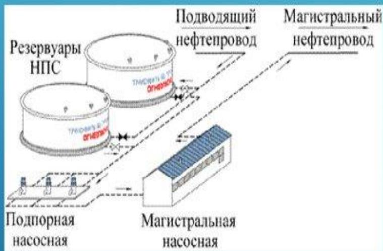
Основной недостаток системы – большие потери от испарения при заполнении-опорожнении резервуаров (потери от «больших дыханий»), а также значительная металлоемкость: сооружение как минимум двух резервуаров и необходимость сооружения подпорной насосной.
