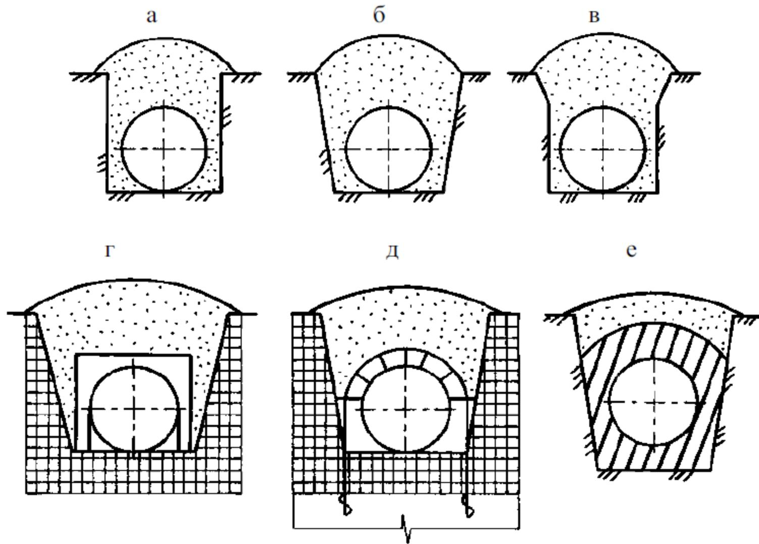
**Рис.2. Подземные схемы прокладки трубопровода:**
