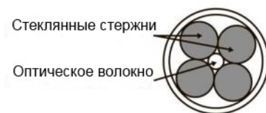
Рис. 16. Соединение оптических волокон с помощью четырехстержневых направляющих
