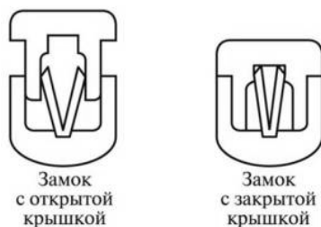
Рис. 19. Соединение оптических волокон с помощью замка Fibrlock
