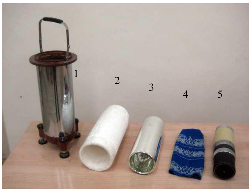
Рис. 2.2. Составные части гравиметра
