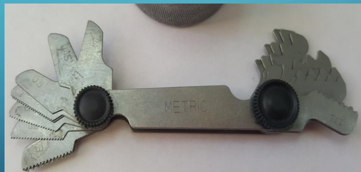
Рисунок - Определение шага резьбы резьбомером
