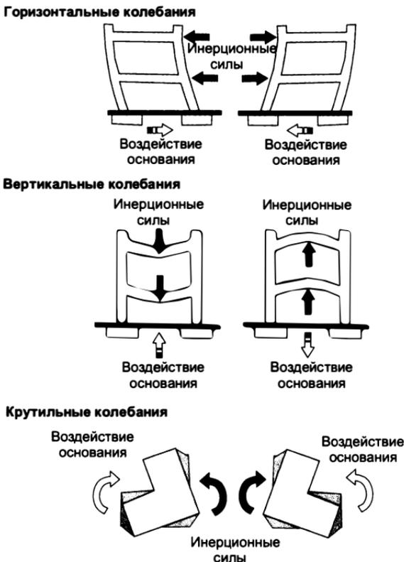
Рис. 10.13. Возникновение инерционных сил
