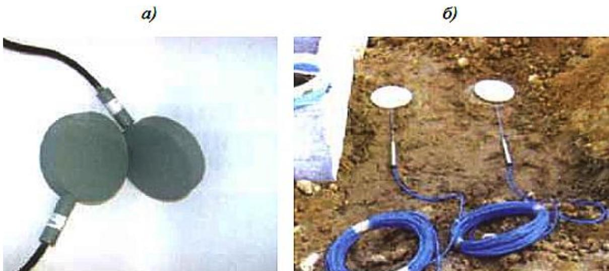
Рис.5.10. Общий вид способа установки датчиков давления в грунтах: а – общий вид датчиков давления; б – установка датчиков давления на грунт, под подошвой фундамента перед бетонированием
