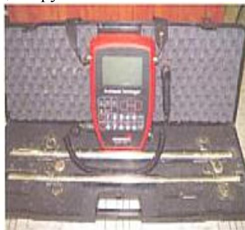
Рис.5.5. Рис.5.6. Пример выполнения инклинометрической скважины в «стене в грунте» Общий вид инклинометра фирмы SISGEO
