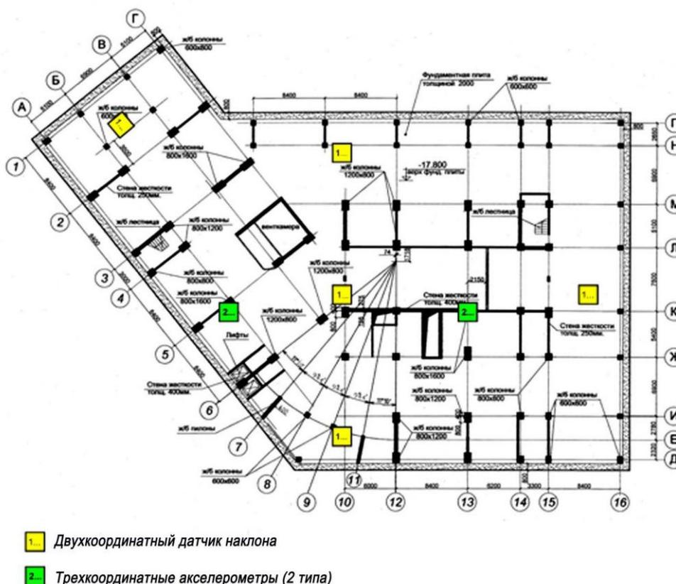
Рис. 6.5,а. Схема размещения измерительных пунктов на планах конструкций минус 5-го (на отм. -17.800 (верх фундаментной плиты)) этажа высотного здания
