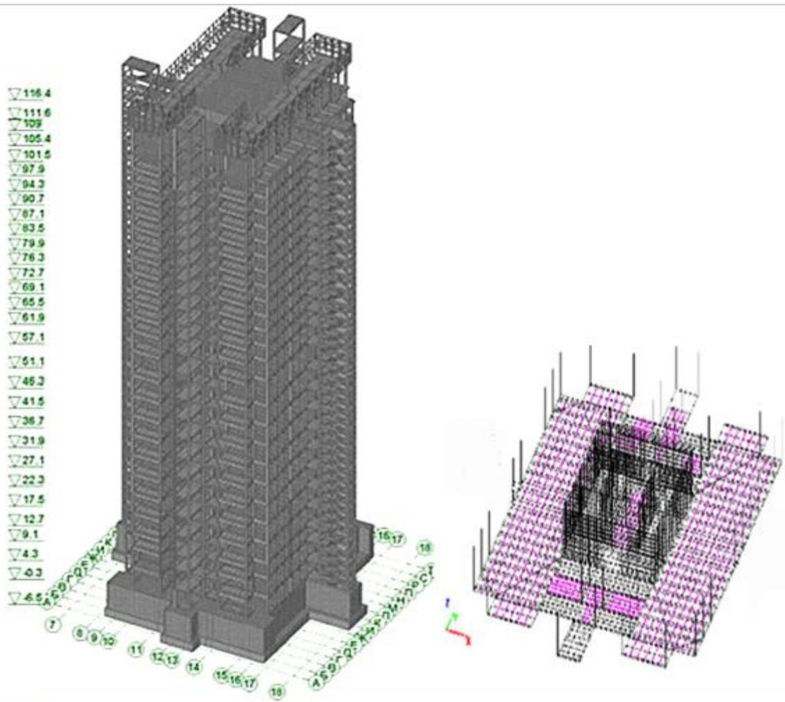
Рис. 7.5. Осадочная модель здания с рамно-связным каркасом
