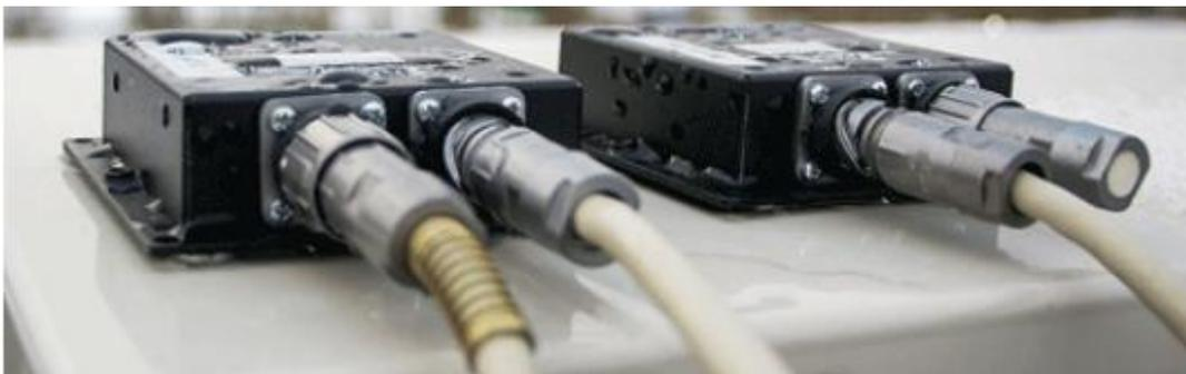
Рис.8. 5. Инклинометров ZETLAB для мониторинга крена.
