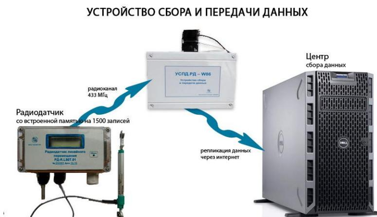
УСПД (*устройство сбора и передачи данных*) представляет собой промышленный компьютер, помещенный в пластиковый бокс. В боксе УСПД также находится GSM-модем, радиомодем 433 МГц, источник бесперебойного питания. Настройка функций сбора и передачи данных
