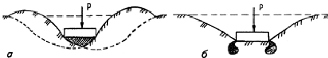
Рис. 3.4. Схемы расчетных моделей, схематизирующих зависимость между осадкой и нагрузкой на грунт: а – основание, работающее в условиях предельного равновесия; б – упругого слоя, работающего в условиях смешанной задачи теории упругости и теории пластичности
