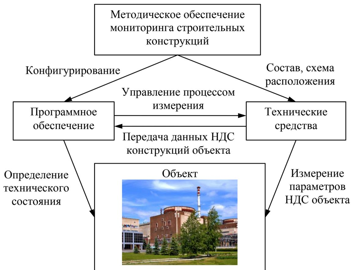
Рис. xxx. Схема взаимодействия элементов системы мониторинга строительных конструкций на объекте (вставить в рисунок свою схему объекта)
