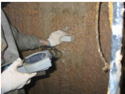
Прибор обеспечивает определение расположения проекций осей стержней арматуры на поверхность бетона:
