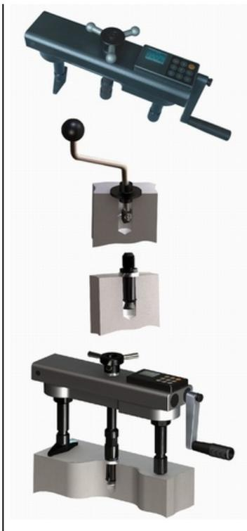
Схема испытания методом отрыва со скалыванием при использовании анкерных устройств
