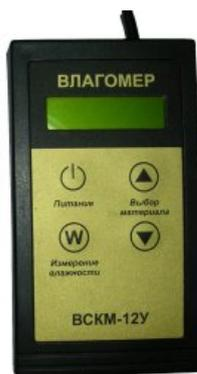
Измерение влажности непосредственно на объекте в настоящее время производят при помощи электронного влагомера ВСКМ-12 или других диэлектрических влагомеров, отвечающих требованиям ГОСТ 21718-84.
