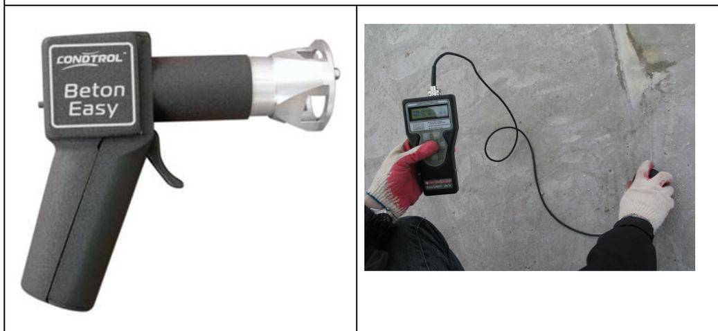
*Измерители прочности бетона фирмы Beton Easy и Склерометр*
