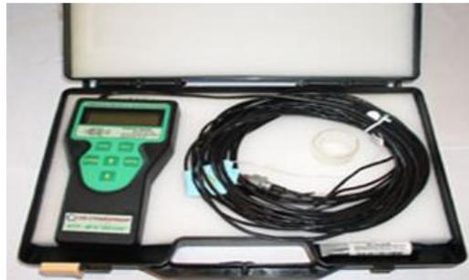
Измеритель плотности тепловых потоков ИПП-МГ4 «Поток» предназначен для измерения плотности тепловых потоков по ГОСТ 25380-82, проходящих через ограждающие конструкции, а также для определения сопротивления ограждающих конструкций.
